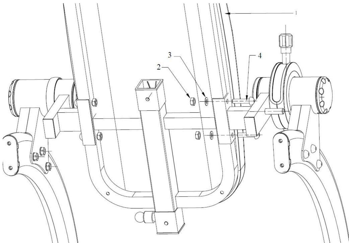
**Шаг 9: Сборка регулировочного кронштейна**
